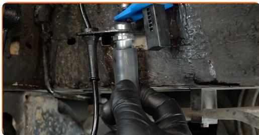
**22** Installare la clip di fissaggio del tubo del freno. Utilizzare un martello.
