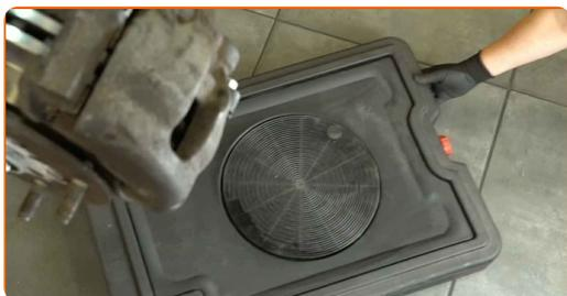
9 Pulire le aree in cui il tubo del freno è collegato alla pinza del freno e al tubo del freno. Utilizzare una spazzola metallica. Utilizzare lo spray WD-40.
