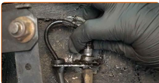
**12** Bloccare il tubo del freno. Utilizzare un fermo per condotti in acciaio.
