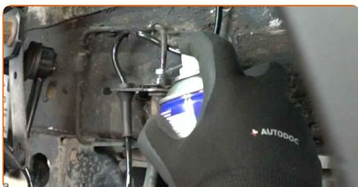
10 Allentare il raccordo a dado che collega il tubo del freno al tubo flessibile del freno. Utilizzare una chiave per dadi svasati da 11 mm. Utilizzare una chiave combinata da 17 mm.
