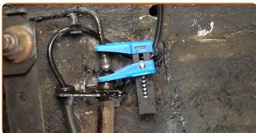
**13** Staccare il tubo flessibile del freno dalla pinza del freno. Utilizzare una chiave per dadi svasati da 11 mm.
