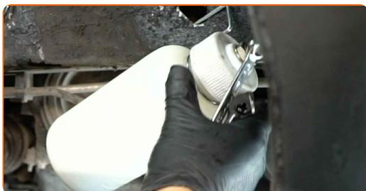
**33** Serrare la vite di spurgo dei freni. Utilizzare una chiave a bussola da 11 mm. Utilizzare una chiave dinamometrica. Coppia di serraggio: 9 N-m.
