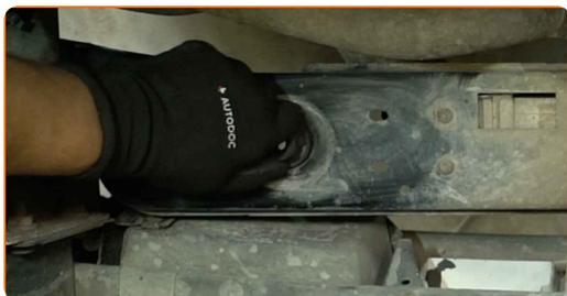
**33** Rimuovere dal radiatore il copriventola di raffreddamento del motore, assieme alla ventola. Utilizzare una leva di montaggio.
