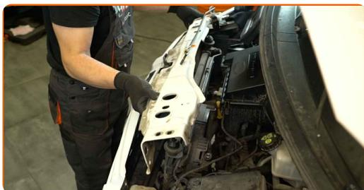
**27** Staccare il connettore del tubo di troppopieno dal radiatore e chiudere il tubo con un tappo. Utilizzare delle pinze per tubi del carburante.
