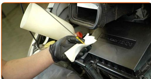
Sostituzione: olio motore e filtro - FORD Transit Mk6 Bus (V347, V348).
