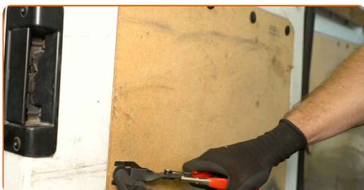
3 Rimuovere la luce della targa. Utilizzare delle pinze a naso lungo.
