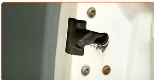
**2** Svitare gli elementi di fissaggio del pannello della portiera. Utilizzare un cacciavite a croce Phillips.
