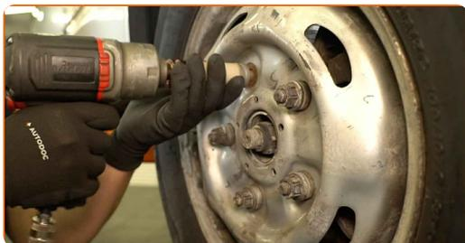
Sostituzione: molle di sospensione - FORD Transit Mk6 Bus (V347, V348).
