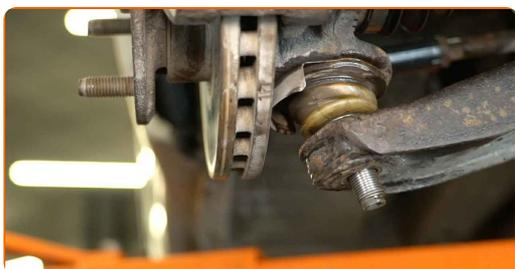
**74** Installare la bielletta della barra stabilizzatrice e avvitare il dado di fissaggio.
