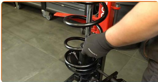
**59** Installare un parapolvere, un tampone di fine corsa e un cuscinetto di supporto.
