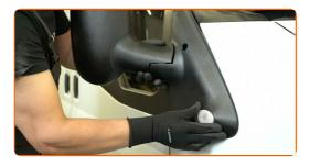
11 Installare i bulloni di fissaggio.
