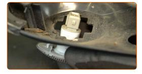
Installare il ripetitore dell'indicatore di direzione su un nuovo specchietto retrovisore.
