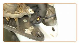
Trattare il connettore del ripetitore dell'indicatore di direzione. Utilizzare uno spray per dispositivi elettronici.
