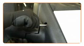
Avvitare gli elementi di fissaggio dello specchietto retrovisore laterale. Utilizzare una chiave a bussola da 8 mm. Utilizzare una chiave a cricchetto.
