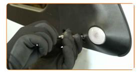
Installare le protezioni degli elementi di fissaggio dello specchietto retrovisore laterale.
