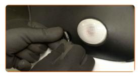
Svitare gli elementi di fissaggio dello specchietto retrovisore laterale. Utilizzare una chiave a bussola da 8 mm. Utilizzare una chiave a cricchetto.
