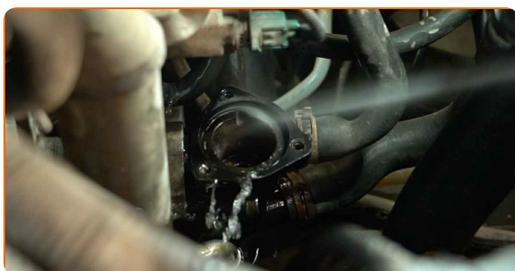
**17** Installare un nuovo termostato.
