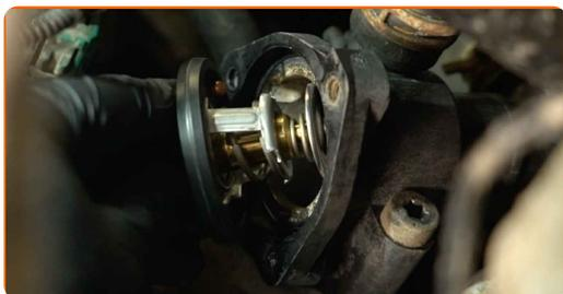
**18** Installare il coperchio dell'alloggiamento del termostato.
