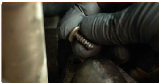
**14** Rimuovere il coperchio dell'alloggiamento del termostato.
