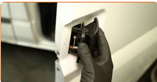
**6** Stringere l'elemento di fissaggio della maniglia della portiera. Utilizzare una chiave a bussola da 10 mm. Utilizzare una chiave dinamometrica. Coppia di serraggio: 10 N·m.
