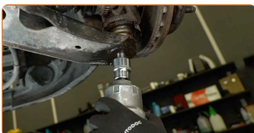
**8** Sollevare il fuso a snodo dello sterzo. Utilizzare un cric per trasmissione o un altro cric per veicoli.
