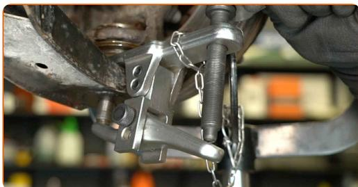
**10** Rimuovere il supporto da sotto il fuso a snodo dello sterzo.
