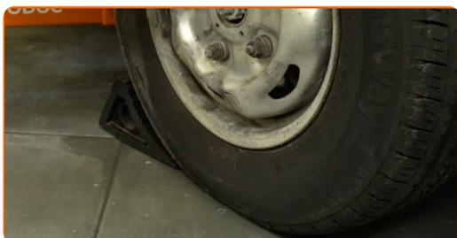
**2** Allentare i dadi delle ruote. Utilizzare una chiave a bussola ad impatto per ruote da 21 mm. Utilizzare un giramaschi.
