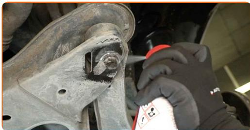
**7** Svitare l'elemento di fissaggio che collega il giunto sferico al braccio di controllo. Utilizzare una chiave a bussola da 24 mm. Utilizzare una chiave a cricchetto.
