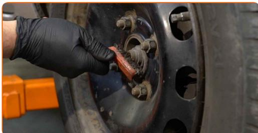
**2** Allenta l'elemento di fissaggio dell'albero di trasmissione. Utilizza una chiave a bussola N°32. Usa un giramaschi.
