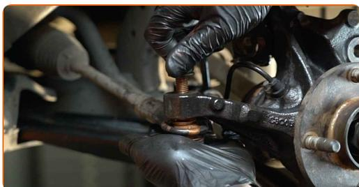
**56** Avvita il dado di serraggio che collega le testine tiranti dello sterzo al fuso a snodo. Utilizza una chiave a bussola N°18. Usa una chiave a cricchetto.
