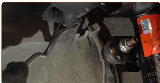
**18** Scollega il connettore del sensore di velocità ABS.
