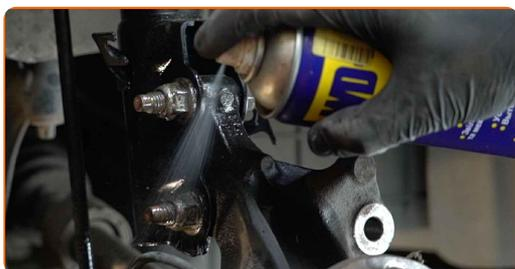
**20** Svita gli elementi di fissaggio che collegano il puntone dell'ammortizzatore al fuso a snodo. Utilizza una chiave combinata N°15. Utilizza una chiave a bussola N°18. Usa una chiave a cricchetto.
