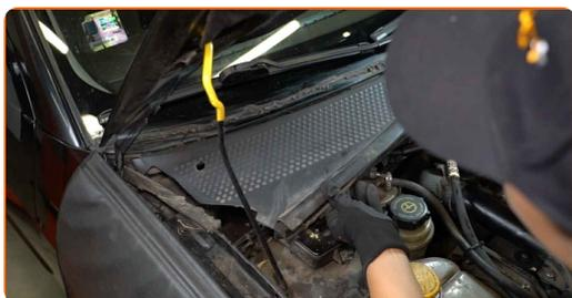
12 Avvita gli elementi di fissaggio della griglia sottoparabrezza posizionata sul lato destro. Usa un cacciavite Phillips.
