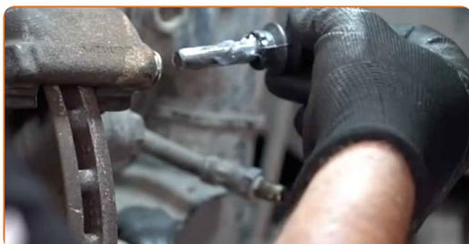
**23** Serra gli elementi di fissaggio della pinza del freno. Usa una chiave HEX N.H7. Usa una chiave dinamometrica. Serralo fino allo coppia di torsione di 35 Nm.
