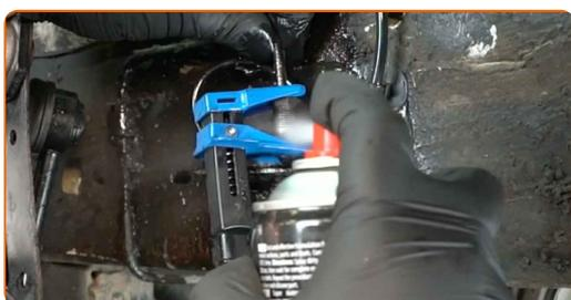
**18** Pulire il punto in cui il tubo flessibile del freno si collega alla pinza. Utilizzare una spazzola metallica. Utilizzare un detergente per freni.
