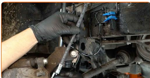
**21** Installare il tubo flessibile del freno nella staffa sulla carrozzeria.
