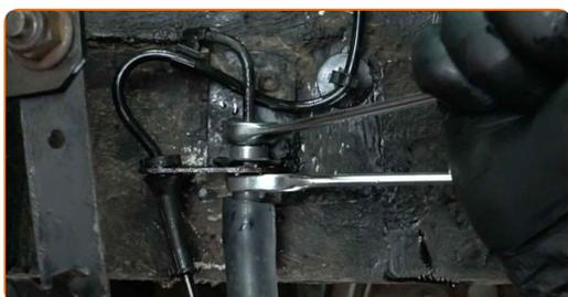
**25** Serrare il raccordo a dado del tubo flessibile del freno sulla pinza del freno. Utilizzare una chiave per dadi svasati da 11 mm. Utilizzare una chiave per dadi svasati da 11 mm. Utilizzare una chiave dinamometrica. Coppia di serraggio: 15 N-m.
