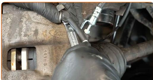
**30** Premere più volte il pedale del freno per eliminare l'aria dal sistema.
