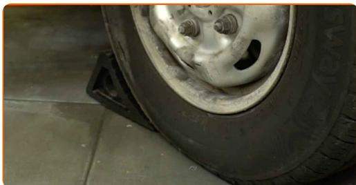
**2** Allentare i dadi delle ruote anteriori. Utilizzare una chiave a bussola ad impatto per ruote da 21 mm. Utilizzare un giramaschi.
