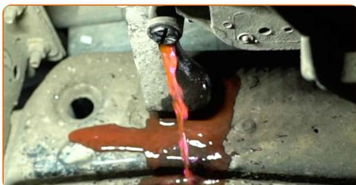
Sostituzione: termostato refrigerante - Ford Transit Mk7 van. AUTODOC raccomanda:
