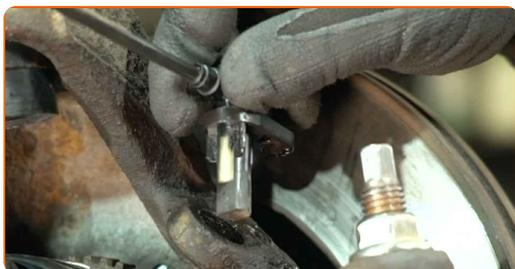
**14** Pulire la sede di montaggio del sensore ABS. Utilizzare una spazzola metallica. Utilizzare uno spray detergente multiuso.
