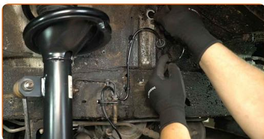
**19** Trattare il connettore del sensore ABS. Utilizzare uno spray per dispositivi elettronici.
