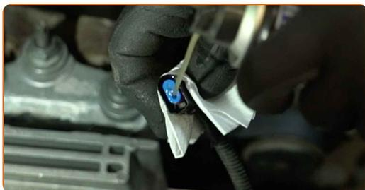
**20** Collegare il connettore del sensore ABS.
