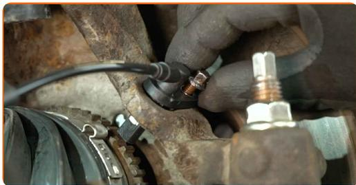
**17** Stringere l'elemento di fissaggio del sensore ABS. Utilizzare una chiave a bussola da 8 mm. Utilizzare una chiave dinamometrica. Coppia di serraggio: 11 N·m.
