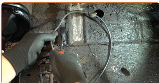
**10** Pulire l'elemento di fissaggio del sensore ABS. Utilizzare una spazzola metallica. Utilizzare lo spray WD-40.
