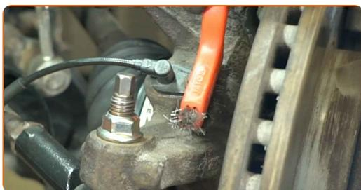
**11** Svitare l'elemento di fissaggio del sensore ABS. Utilizzare una chiave a bussola da 8 mm. Utilizzare una chiave a cricchetto.
