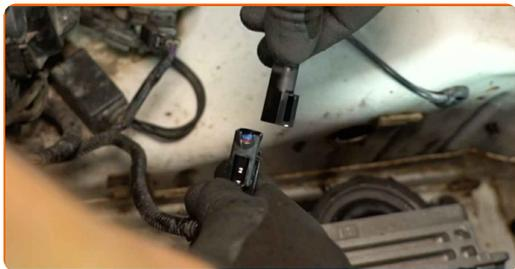
**9** Scollegare il cablaggio del sensore ABS. Utilizzare uno strumento per la rimozione delle finiture in plastica. Utilizzare uno strumento per la rimozione delle clip.
