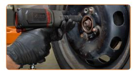
Rimettere il veicolo per terra e, lavorando in ordine incrociato, serrare i bulloni di fissaggio delle ruote. Usa la 19 chiave a bussola per dadi cerchio ruota n.19. Usa una chiave dinamometrica. Serralo fino allo coppia di torsione di 110 Nm.
