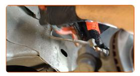
Installare una nuova barra, serrarne gli elementi di montaggio. Utilizza una chiave combinata N°15. Usa una chiave HEX N.H5. Usa una chiave a cricchetto.
