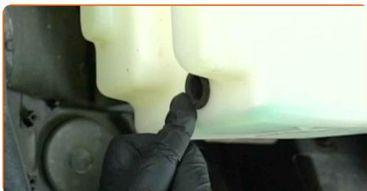
**20** Installare una nuova pompa lavavetri del parabrezza.
