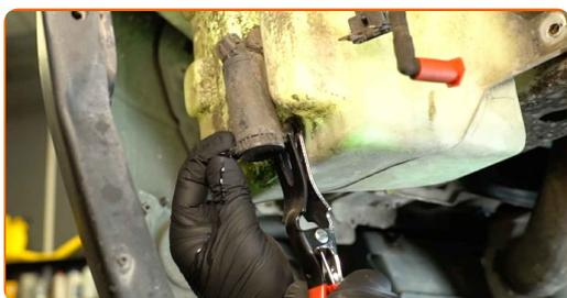
**17** Rimuovere la guarnizione della pompa lavavetri. Utilizzare una leva di montaggio.
