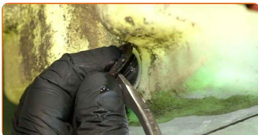
**18** Pulire la sede di montaggio della pompa lavavetri del parabrezza. Utilizzare uno spray detergente multiuso.
