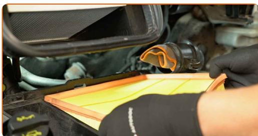
**9** Svitare gli elementi di fissaggio dell'alloggiamento del filtro dell'aria. Utilizzare una chiave a bussola da 10 mm. Utilizzare una chiave a cricchetto.
