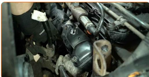
**51** Stringere gli elementi di fissaggio del collettore di aspirazione. Utilizzare una chiave a bussola da 10 mm. Utilizzare una chiave dinamometrica. Coppia di serraggio: 25 N-m.
