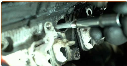
**40** Serrare le candele. Utilizzare una presa per candele da 10 mm. Utilizzare una chiave dinamometrica. Coppia di serraggio: 13 N-m.
