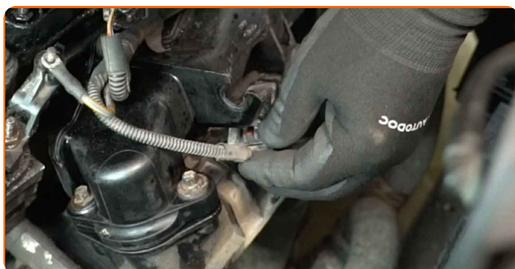
**64** Collegare il terminale del cavo di alimentazione delle candele e avvitare il dado che lo fissa. Utilizzare una chiave a bussola da 8 mm. Utilizzare una chiave a cricchetto.
