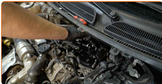
**23** Collegare i tubi del carburante al filtro del carburante e bloccare i ganci di fissaggio.
