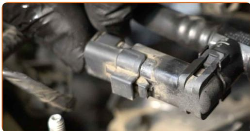
**25** Pulisci gli elementi di fissaggio dei tubi di rifornimento carburante. Usa un detergente spray multiuso.
