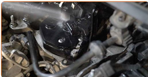
**26** Avvitare i bulloni di fissaggio della staffa del filtro carburante. Utilizza una chiave a bussola N°8. Usa una chiave a cricchetto.
