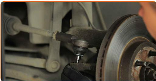
**16** Serra il bullone di fissaggio che collega la testina tirante al fuso a snodo. Utilizza una chiave a bussola N°15. Usa una chiave dinamometrica. Serralo fino alla coppia di torsione di 40 Nm.
