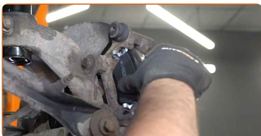
**26** Tratta con del prodotto il pistone della pinza freno. Usare una spazzola pulente in nylon. Usa un pulitore freni.
