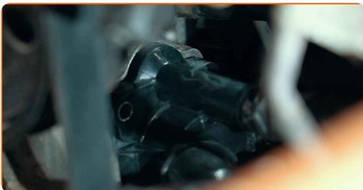
**27** Stringere gli elementi di fissaggio dell'alloggiamento del termostato. Utilizza una chiave a bussola N°8. Usa una chiave dinamometrica. Serralo fino allo coppia di torsione di 6 Nm.
