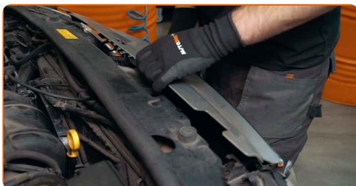
**36** Avvita gli elementi di fissaggio della griglia del radiatore.
