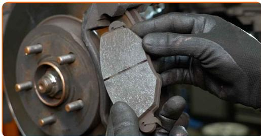
**12** Pulisci gli elementi di fissaggio del supporto pinza freno. Usa una spazzola metallica. Usa lo spray WD-40.
