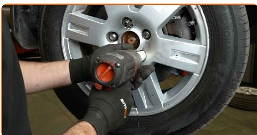
**29** Rimettere il veicolo per terra e, lavorando in ordine incrociato, serrare i bulloni di fissaggio delle ruote. Usa la chiave a bussola per dadi cerchio ruota n.19. Usa una chiave dinamometrica. Serralo fino allo coppia di torsione di 90 Nm.
