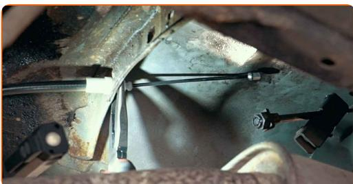
**17** Rimuovere il cavo del freno di stazionamento.
