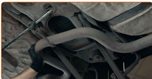
**11** Abbassa il cric per trasmissione idraulica di 10-15 cm.
