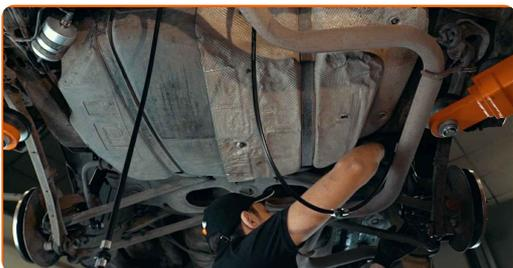
**19** Fissare il cavo del freno di stazionamento.
