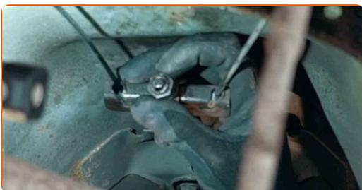
**16** Sgancia il cavo del freno di stazionamento. Usa delle pinze a becchi lunghi.
