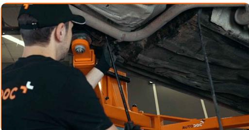
**9** Sorreggere il silenziatore. Usa un cric idraulico per trasmissione.
