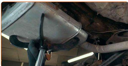
**12** Svitare gli elementi di fissaggio dello scudo termico dello scarico. Utilizza una chiave a bussola N°10. Usa una chiave a cricchetto.
