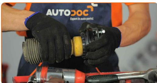
**43** Serrare la vite dell'asta pistone supporto ammortizzazione. Utilizza una chiave combinata N°18. Usa una chiave HEX N.H6. Usa una chiave dinamometrica. Serralo fino allo coppia di torsione di 58 Nm.
