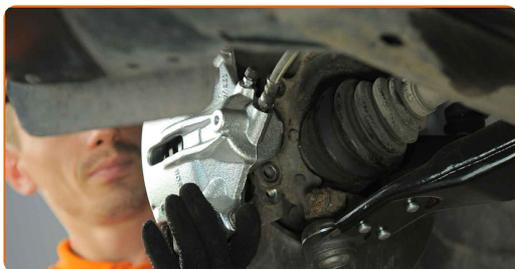
**62** Monta i bulloni di fissaggio (2 pezzi).
