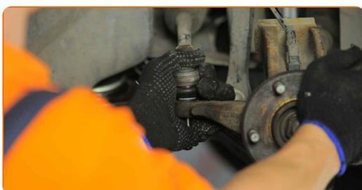
**66** Serra il bullone di fissaggio che collega la testina tirante al fuso a snodo. Utilizza una chiave a bussola N°15. Usa una chiave dinamometrica. Serralo fino allo coppia di torsione di 40 Nm.
