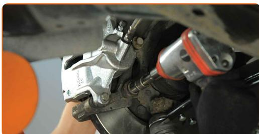
**64** Fissare sul montante il tubo dell'impianto freni.
