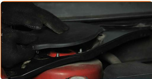
**50** Rimuovi la copertura di protezione del parafrango.
