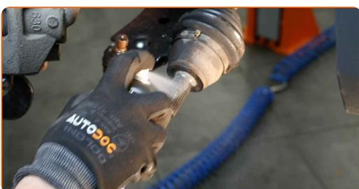
**54** Installa l'albero di trasmissione all'interno del mozzo della ruota.
