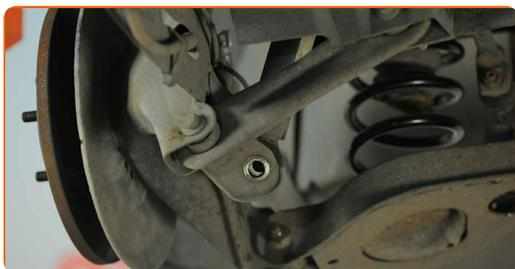
**10** Svita l'elemento di fissaggio superiore dell'ammortizzatore. Utilizza una chiave combinata N°18. Utilizza una chiave a bussola N°15. Usa una chiave a cricchetto. Usa un giramaschi.
