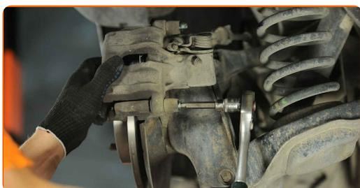
**24** Montare i tappi dei parapolvere delle guide pinza freno.
