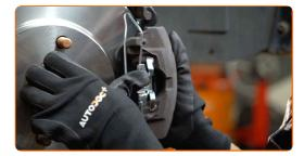
Serra gli elementi di fissaggio della pinza del freno. Usa una chiave HEX N.H7. Usa una chiave dinamometrica. Serralo fino allo coppia di torsione di 28 Nm.
