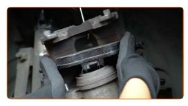
Montare la pinza del freno e fissarla.
