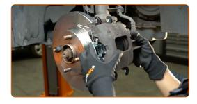
Installare la molla di fissaggio della pinza freno.
