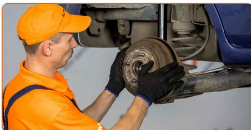
**18** Serra l'elemento di fissaggio del cuscinetto del mozzo ruota. Utilizza una chiave a bussola N°30. Usa una chiave dinamometrica. Serralo fino allo coppia di torsione di 235 Nm.
