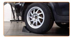
Allentare i bulloni di fissaggio della ruota. Usa la chiave a bussola per dadi cerchio ruota n.19.
