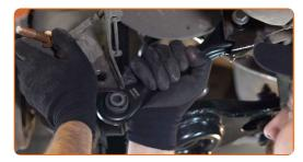
Installa gli elementi di fissaggio del braccio di sospensione. Usa un piede di porco.
