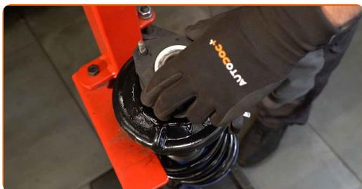
**44** Serrare la vite dell'asta pistone supporto ammortizzazione. Utilizza una chiave a bussola N°19. Usa una chiave HEX N.H7. Usa una chiave dinamometrica. Serralo fino allo coppia di torsione di 55 Nm.
