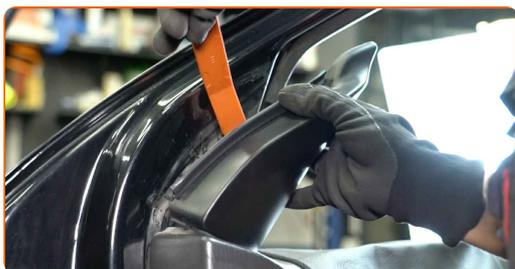
**4** Scollegare i cavi dello specchietto retrovisore. Usa uno strumento per estrazione clip.
