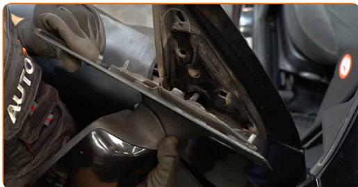
**8** Pulire la sede di montaggio dello specchietto retrovisore. Usa lo spray WD-40.
