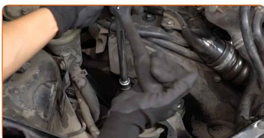
**9** Svitare gli elementi di fissaggio che collegano il supporto del motore alla carrozzeria. Utilizza una chiave a bussola N°16. Usa una chiave a cricchetto.
