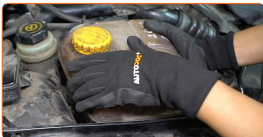
**20** Fissare il serbatoio del liquido di raffreddamento usando i suoi fermi.
