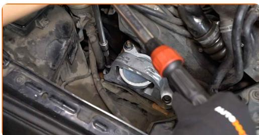
**18** Tratta con del prodotto gli elementi di fissaggio del supporto del motore. Usa il grasso al rame.
