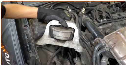
Sostituzione: supporto motore - FORD Focus Mk1 Van / Station Wagon (DNW).
