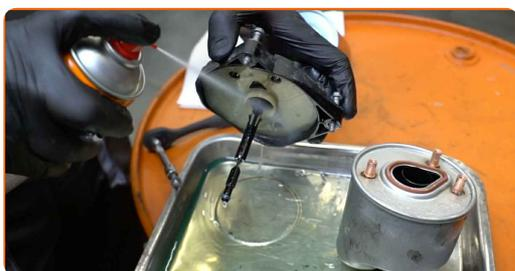
**15** Installare e serrare la calotta dell'alloggiamento filtro carburante. Usa la chiave Torx T15. Usa una chiave a cricchetto.
