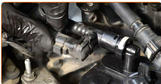
**24** Collega il connettore del sensore di pressione carburante.
