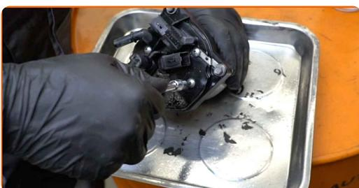
**13** Rimuovere il coperchio dell'alloggiamento del filtro carburante.
