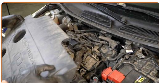
Sostituzione: filtro carburante - FORD FOCUS III Turnier. Il consiglio di AUTODOC:
