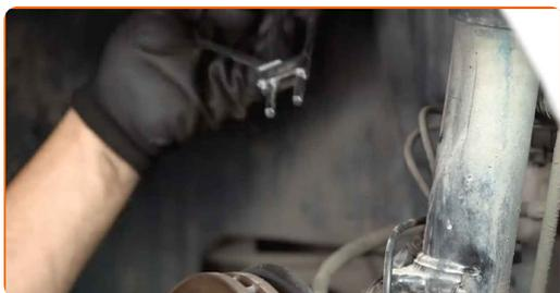
**23** Pulire il sostegno pinza freno da sporco e polvere. Usa una spazzola metallica. Usa un pulitore freni.
