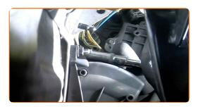
Scollega il connettore del pedale dell'acceleratore.
