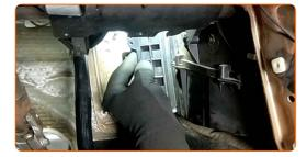
Avvita gli elementi di fissaggio del coperchio del filtro abitacolo. Utilizza una chiave a bussola N°8. Usa una chiave a cricchetto.
