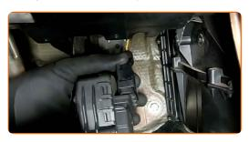
Reinstallare il pedale dell'acceleratore.
