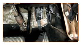
Riponi il pedale dell'acceleratore nella sua posizione iniziale e avvita i suoi elementi di fissaggio. Utilizza una chiave a bussola N°10. Usa una chiave a cricchetto.
