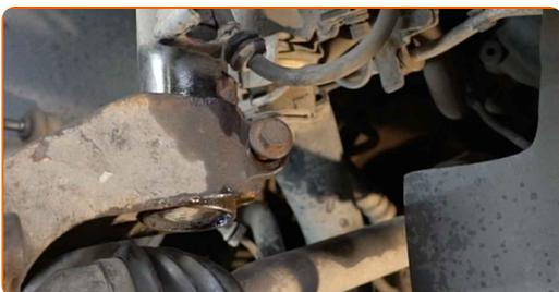
**46** Avvita l'elemento di fissaggio che collega il puntone dell'ammortizzatore al fuso a snodo. Utilizza una chiave a bussola N°15. Usa una chiave a cricchetto.
