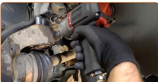
**47** Avvita gli elementi di fissaggio che collegano il giunto sferico al fuso a snodo. Utilizza una chiave combinata N°21.
