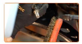
Tratta con del prodotto le sedi di montaggio delle testine tiranti dello sterzo. Usa il grasso al rame.
