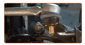
Serra il bullone di fissaggio che collega la testina tirante al fuso a snodo. Utilizza una chiave a bussola N°15. Usa una chiave dinamometrica. Serralo fino allo coppia di torsione di 48 Nm.
