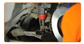
Serrare il controdado del gambo. Utilizza una chiave combinata N°24. Usa una chiave dinamometrica. Serralo fino allo coppia di torsione di 62 Nm.
