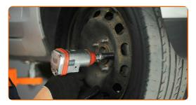
Rimettere il veicolo per terra e, lavorando in ordine incrociato, serrare i bulloni di fissaggio delle ruote. Usa la chiave a bussola per dadi cerchio ruota n.19. Usa una chiave dinamometrica. Serralo fino allo coppia di torsione di 120 Nm.
