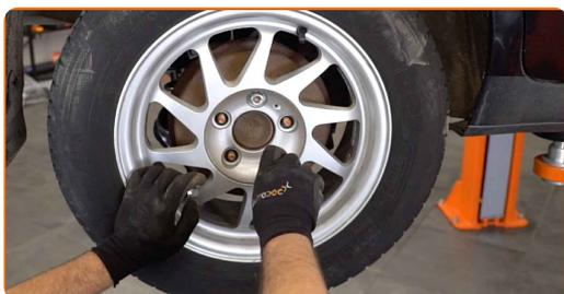
**28** Rimettere il veicolo per terra e, lavorando in ordine incrociato, serrare i bulloni di fissaggio delle ruote. Usa la chiave a bussola per dadi cerchio ruota n.19. Usa una chiave dinamometrica. Serralo fino allo coppia di torsione di 110 Nm.
