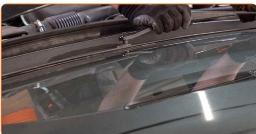
**56** Serra gli elementi di fissaggio dei bracci del tergicristallo. Utilizza una chiave a bussola N°15. Usa una chiave dinamometrica. Serralo fino allo coppia di torsione di 10 Nm.
