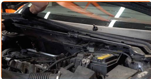
**11** Allenta gli elementi di fissaggio superiori del supporto dell'ammortizzatore. Utilizza una chiave a bussola N°13. Usa una chiave a cricchetto.
