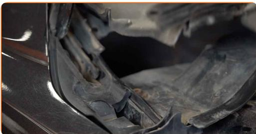
**9** Svita gli elementi di fissaggio della griglia sottoparabrezza di plastica inferiore. Usa la chiave Torx T 30. Usa una chiave a cricchetto.
