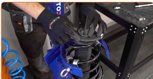
**36** Serrare la vite dell'asta pistone supporto ammortizzazione. Usa la chiave Torx T 30. Utilizza una chiave combinata N°19. Usa una chiave dinamometrica. Serralo fino allo coppia di torsione di 50 Nm.
