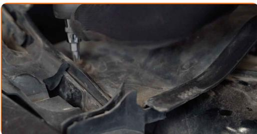
**10** Rimuovi la griglia sottoparabrezza di plastica inferiore.
