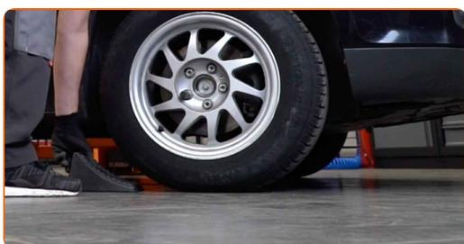
**13** Allentare i bulloni di fissaggio della ruota. Usa la chiave a bussola per dadi cerchio ruota n.19.
