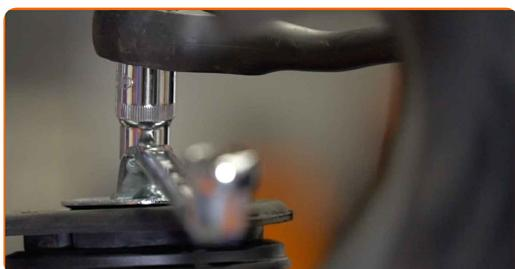
Sostituzione: molle di sospensione - FORD Focus II Hatchback (DA\_, HCP, DP).
