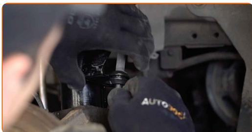
**47** Fissare il puntone della barra stabilizzatrice trasversale sul supporto di ammortizzazione. Utilizza una chiave a bussola N°15. Usa una chiave dinamometrica. Serralo fino allo coppia di torsione di 48 Nm.
