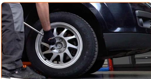
**14** Sollevare la parte anteriore del veicolo e fissarlo per mezzo di appoggi.
