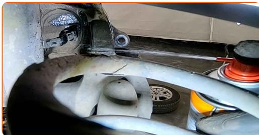
**17** Scollega il connettore del sensore di velocità ABS. Usa un giravite piatto.
