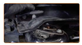
Installa gli elementi di fissaggio della griglia sottoparabrezza di plastica.
