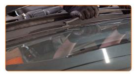
Serra gli elementi di fissaggio dei bracci del tergicristallo. Utilizza una chiave a bussola N°15. Usa una chiave dinamometrica. Serralo fino allo coppia di torsione di 10 Nm.
