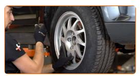
Sostituzione: supporto ammortizzatore - FORD Focus C-Max (DM2). Gli esperti di AUTODOC raccomandano:
