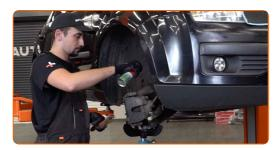
Installare il supporto di ammortizzazione nell'arco passaruota.
