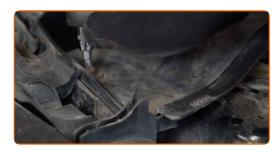
Rimuovi la griglia sottoparabrezza di plastica inferiore.
