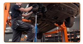
Installa e stringi il bullone nuovo del fuso a snodo. Utilizza una chiave a bussola N°18. Usa una chiave a cricchetto. Usa una chiave dinamometrica. Serralo fino allo coppia di torsione di 90 Nm.
