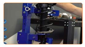
Pulisci le sedi di montaggio del puntone dell'ammortizzatore. Usa una spazzola metallica. Usa lo spray WD-40.
