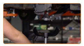
Sgancia gli elementi di fissaggio che collegano il puntone dell'ammortizzatore al fuso a snodo. Usa una chiave a bussola specifica per rimuovere l'ammortizzatore. Usa un martello. Usa uno scalpello piatto per la lavorazione dei metalli.
