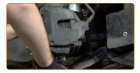
Svitare il perno di fissaggio superiore del supporto di ammortizzazione.
