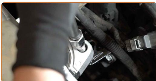
**15** Stringere gli elementi di fissaggio che collegano il supporto del motore alla carrozzeria. Utilizza una chiave a bussola N°18. Usa una chiave dinamometrica. Serralo fino allo coppia di torsione di 65 Nm.
