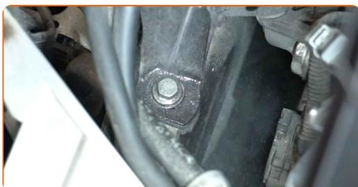
**8** Svitare gli elementi di fissaggio che collegano il supporto del motore alla carrozzeria. Utilizza una chiave a bussola N°18. Usa una chiave a cricchetto.
