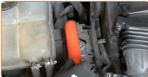
**6** Svita gli elementi di fissaggio superiori del supporto del motore. Utilizza una chiave a bussola N°16. Usa una chiave a cricchetto.
