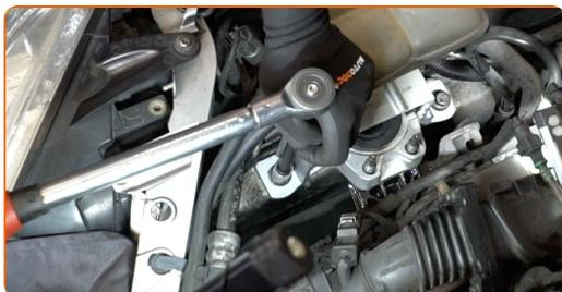
**16** Tratta con del prodotto gli elementi di fissaggio del supporto del motore. Usa il grasso al rame.
