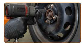
Rimettere il veicolo per terra e, lavorando in ordine incrociato, serrare i bulloni di fissaggio delle ruote. Usa la chiave a bussola per dadi cerchio ruota n.19. Usa una chiave dinamometrica. Serralo fino allo coppia di torsione di 110 Nm.
