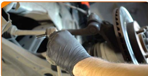
Sostituzione: biellette barra stabilizzatrice - FORD Fiesta Mk6 Van. AUTODOC raccomanda:
