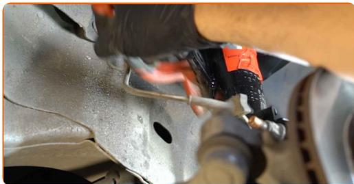
**11** Installare una nuova barra, serrarne gli elementi di montaggio. Utilizza una chiave combinata N°15. Usa una chiave HEX N.H5. Usa una chiave a cricchetto.
