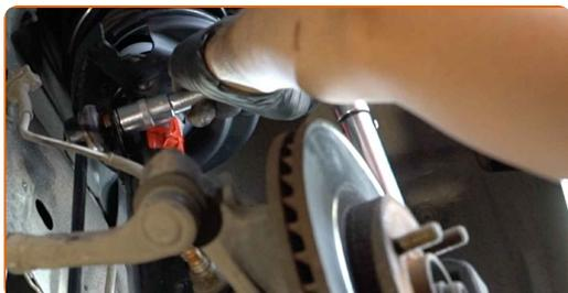
**13** Serra gli elementi di fissaggio che collegano il tirante della barra stabilizzatrice alla barra. Utilizza una chiave a bussola N°15. Usa una chiave dinamometrica. Serralo fino allo coppia di torsione di 48 Nm.
