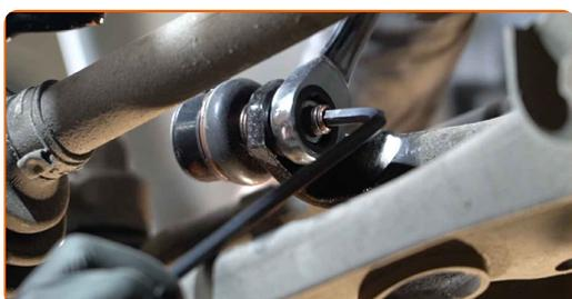
**12** Serra gli elementi di fissaggio che collegano il tirante della barra stabilizzatrice al puntone dell'ammortizzatore. Utilizza una chiave a bussola N°15. Usa una chiave dinamometrica. Serralo fino allo coppia di torsione di 48 Nm.
