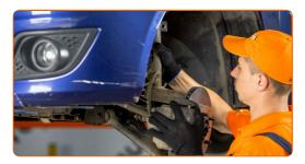
Fissare il supporto di ammortizzazione sul fuso a snodo. Usa un martello. Usa un piede di porco.
