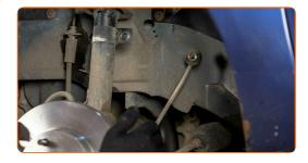
Estrarre la staffa di fissaggio e rimuovere il tubo flessibile del freno dalla staffa di sostegno del supporto di ammortizzazione. Usa un giravite piatto. Usa delle pinze.
