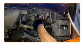
Rimuovi i bulloni di fissaggio. Scollegare il fuso a snodo dal supporto di ammortizzazione. Usa un martello.
