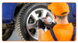
Rimettere il veicolo per terra e, lavorando in ordine incrociato, serrare i bulloni di fissaggio delle ruote. Usa la chiave a bussola per dadi cerchio ruota n.19. Usa una chiave dinamometrica. Serralo fino allo coppia di torsione di 95 Nm.
