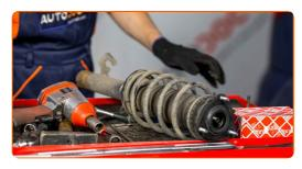
Avvita l'elemento di fissaggio superiore del montante supporto ammortizzazione.
