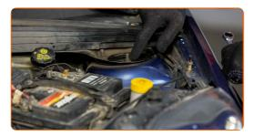
Svita l'elemento di fissaggio superiore del montante supporto ammortizzazione. Utilizza una chiave combinata N°13.
