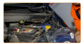
Stringi l'elemento di fissaggio superiore del supporto di ammortizzazione. Utilizza una chiave combinata N°13. Usa una chiave dinamometrica. Serralo fino allo coppia di torsione di 30 Nm.
