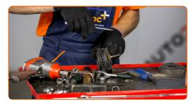
Installare il nuovo appoggio del supporto di ammortizzazione nel cuscinetto di spinta.
