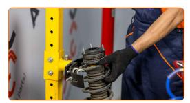
Installare il supporto di ammortizzazione nell'arco passaruota.
