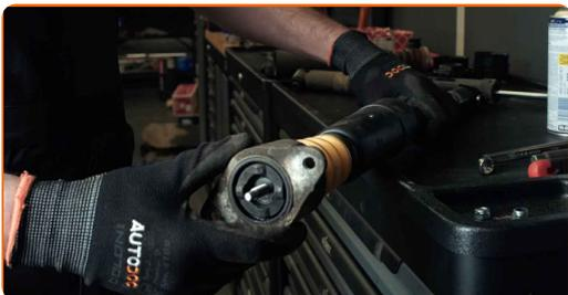
**19** Stringere il dado dell'asta dell'ammortizzatore. Utilizza una chiave combinata N°13. Usa la chiave a bussola per ammortizzatore N°DD6. Usa una chiave dinamometrica. Serralo fino allo coppia di torsione di 25 Nm.
