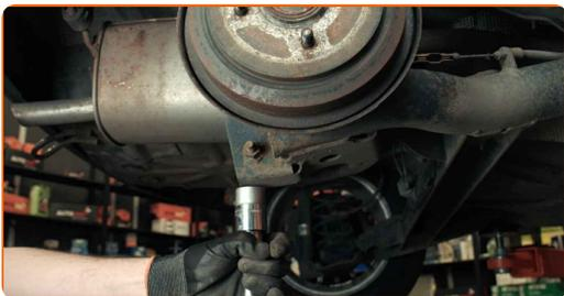
**10** Svita l'elemento di fissaggio superiore dell'ammortizzatore. Utilizza una chiave a bussola N°10. Usa una chiave a cricchetto.
