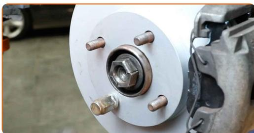
**63** Serra il dado dell'albero di trasmissione. Utilizza una chiave a bussola N°32. Usa una chiave dinamometrica. Serralo fino alla coppia di torsione di 290 Nm.
