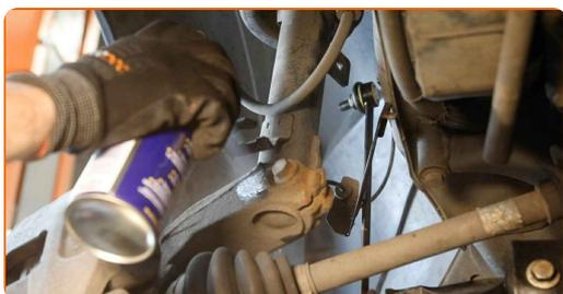
**16** Svita gli elementi di fissaggio che collegano il puntone dell'ammortizzatore al fuso a snodo. Utilizza una chiave a bussola N°15. Usa un giramaschi.
