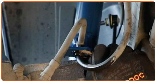
**60** Installa il puntone stabilizzatore trasversale.
