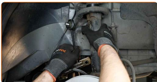
**13** Rimuovi il clip di ritenuta del tubo flessibile del freno. Usa un piede di porco.
